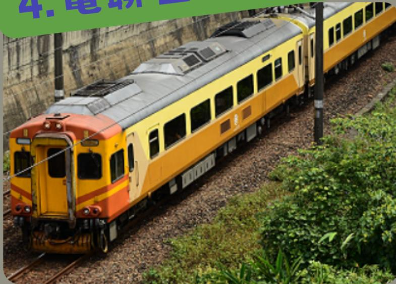
電聯自強號E300，1989年由義大利引進、同年首次營運、較前兩代行駛更快、將捲簾式顯示器改為KED顯示器、摺疊車門改為滑動門、因原廠倒閉無法修理、於2021年停運、2023年陸續拆除
